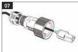
07 Steek de kabel door de warterl tot aan de kern.
