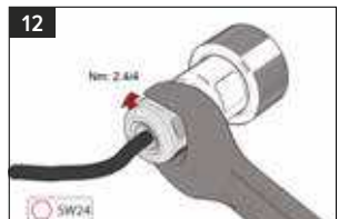
12 Ziehen Sie die Kabelverschraubung mit 2,4/4 Nm fest.
