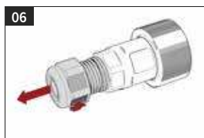
06 Maak de warterl aan de andere zijde van de connector los.
