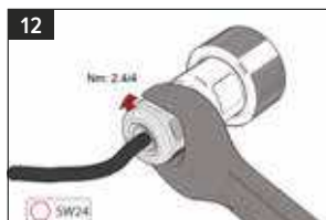
12 Draai de warterl aan met 2,4/4 Nm.
